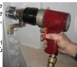
velocità: le più lente per avvitare, le più veloci per forare. In alcuni modelli, il tasto funziona in modo analogico e la velocità del mandrino varia in modo proporzionale alla sua pressione.
